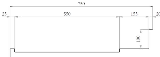
Dessus entièrement en INOX AISI 304L, en une seule pièce en tôle d'épaisseur 15/10<sup>ème</sup>, avec dosseret plat 100 x 20 mm et une cuve L400 x l400 x H250 mm (bonde, tube surverse et siphon PVC inclus), à 200 mm de l'accrochage machine (à 77 mm pour la table de 600mm)
