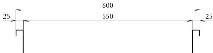
Plateau 15/10<sup>ème</sup> INOX AISI 304L, largeur intérieure 550 mm, hauteur de roulement 875 mm
