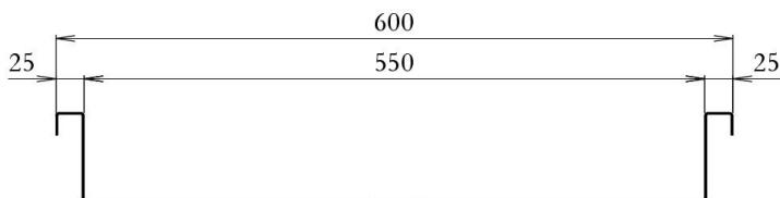
Plateau 15/10<sup>ème</sup> INOX AISI 304L, largeur intérieure 550 mm, hauteur de roulement 875 mm
