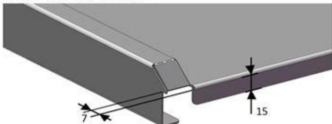
Dessus : entièrement en inox AISI 304L, en une seule pièce en tôle d'épaisseur 15/10ème, sans plage ni dossier arrière
