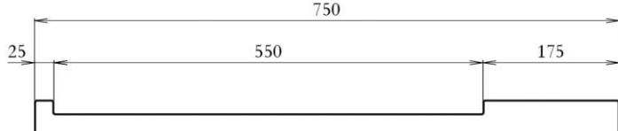
Dessus : entièrement en inox AISI 304L, en une seule pièce en tôle d'épaisseur 15/10ème, avec plage arrière et sans dosseret
