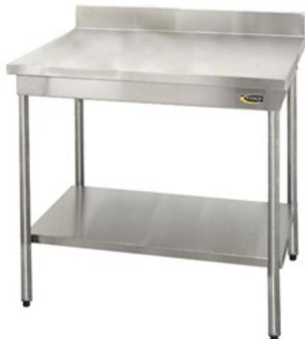
Dessus INOX AISI 304L renforcé par un panneau collé en mélaminé hydrofuge de 19 mm. Coins pliés, bords droits tombés de 40 mm, avec étagère basse et dosseret Hauteur : 100 mm, Epaisseur : 20 mm
