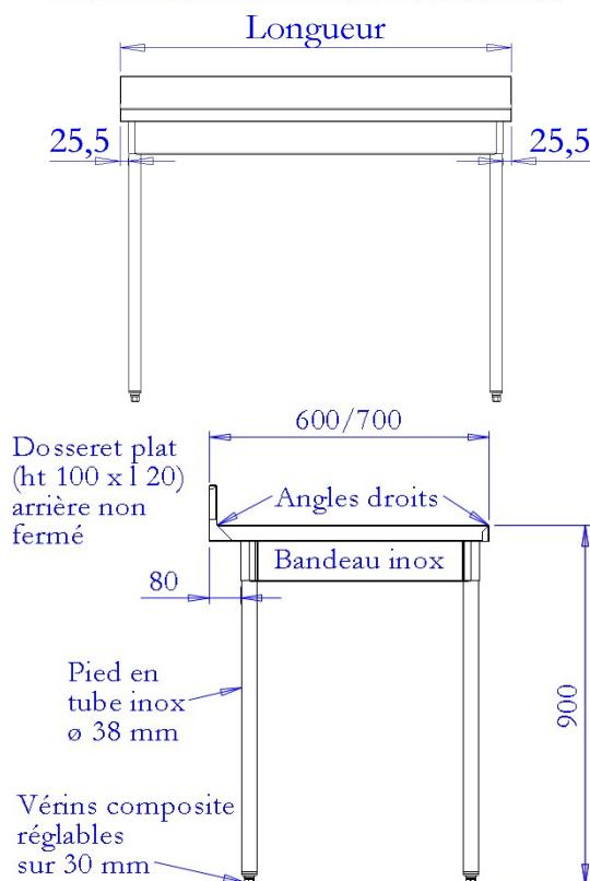
Dessus INOX AISI 304L renforcé par un panneau collé en mélaminé hydrofuge de 19 mm. Coins pliés, bords droits tombés de 40mm, avec dosseret Hauteur : 100 mm, Epaisseur : 20 mm
