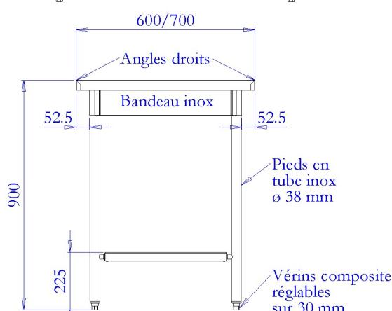
Dessus INOX AISI 304L renforcé par un panneau collé en mélaminé hydrofuge de 19 mm. Coins pliés, bords droits tombés de 40 mm, avec étagère basse
