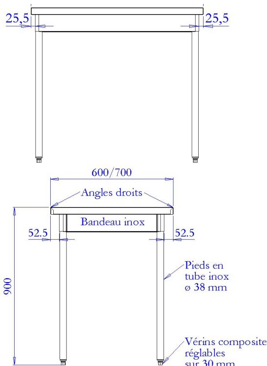
Dessus INOX AISI 304L renforcé par un panneau collé en mélaminé hydrofuge de 19 mm. Coins pliés, bords droits tombés de 40 mm
