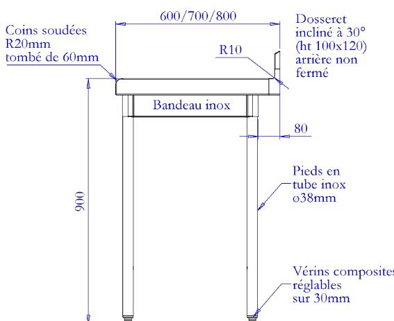
Dessus : INOX AISI 304 L épaisseur 15/10 mm, renforcé par un panneau collé en mélaminé hydrofuge épaisseur 19 mm. Bords rayonnés 20 mm, tombés de 60mm, coins soudés. Dosseret arrière 100 x 20 mm, incliné à 30° et rayon de 10 mm à sa base. Vérins ABS réglables sur 30 mm
