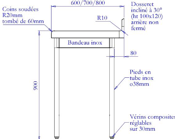
Dessus : INOX AISI 304 L épaisseur 15/10 mm, renforcé par un panneau collé en mélaminé hydrofuge épaisseur 19 mm. Bords rayonnés 20 mm, tombés de 60mm, coins soudés. Dosseret arrière 100 x 20 mm, incliné à 30° et rayon de 10 mm à sa base. Vérins ABS réglables sur 30 mm.
