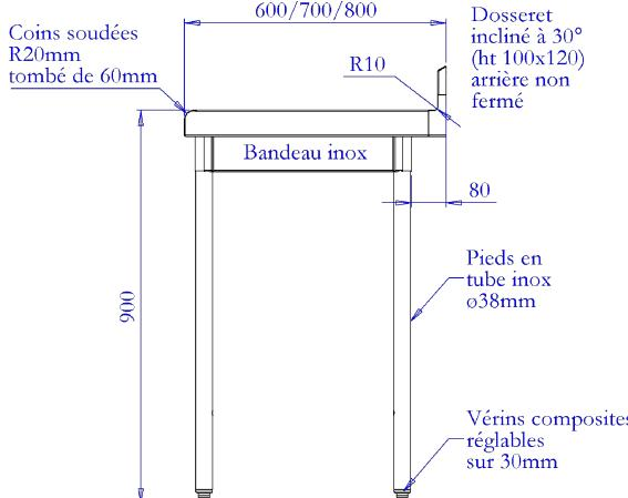
Dessus : INOX AISI 304 L épaisseur 15/10 mm, renforcé par un panneau collé en mélaminé hydrofuge épaisseur 19 mm. Bords rayonnés 20 mm, tombés de 60mm, coins soudés. Dosseret arrière 100 x 20 mm, incliné à 30° et rayon de 10 mm à sa base
