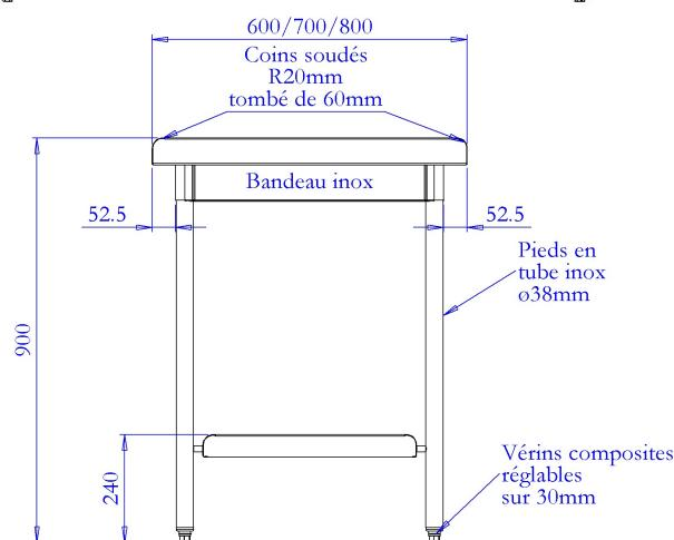
Dessus : INOX AISI 304 L épaisseur 15/10 mm, renforcé par un panneau collé en mélaminé hydrofuge épaisseur 19 mm. Bords rayonnés 20 mm, tombés de 60mm, coins soudés
