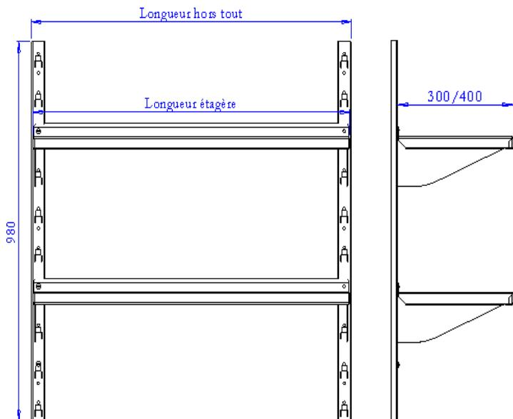
Etagère en tôle INOX AISI 304L épaisseur 15/10ème à bords droits avec dossier arrière simple d'une hauteur de 35mm
