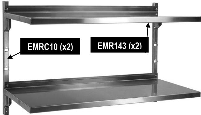
Etagère en tôle INOX AISI 304L épaisseur 15/10<sup>ème</sup> à bords droits avec dossier arrière simple d'une hauteur de 35mm
