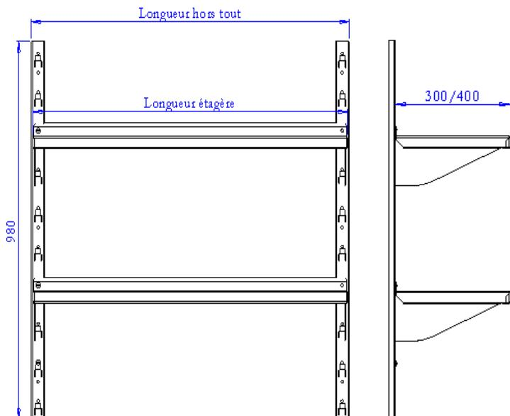
Etagère en tôle INOX AISI 304L épaisseur 15/10<sup>ème</sup> à bords droits avec dossier arrière simple d'une hauteur de 35mm
