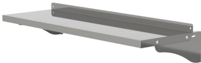
Etagère en tôle d'INOX AISI 304L épaisseur 15/10èmes à bords droits, avec dosseret arrière d'une hauteur de 35 mm
