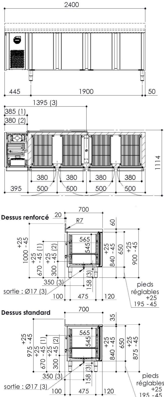
(1) : Raccordement électrique
